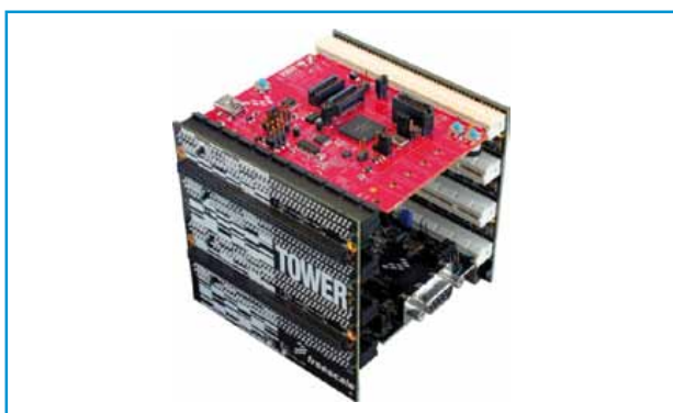
Illustration 5 : Carte d'évaluation Freescale. La carte supérieure est la plate-forme processeur. La carte inférieure propose un port série, un port Ethernet, des ports USB. La carte additionnelle MRAM n'est pas présente sur cette photo.
